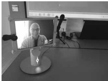
Abb. 23: Wilfried Frei nutzt einen Telekommunikationsroboter für die Online-Teilnahme an einem Workshop (das Gerät hält ein Tablet und kann ferngesteuert werden).
